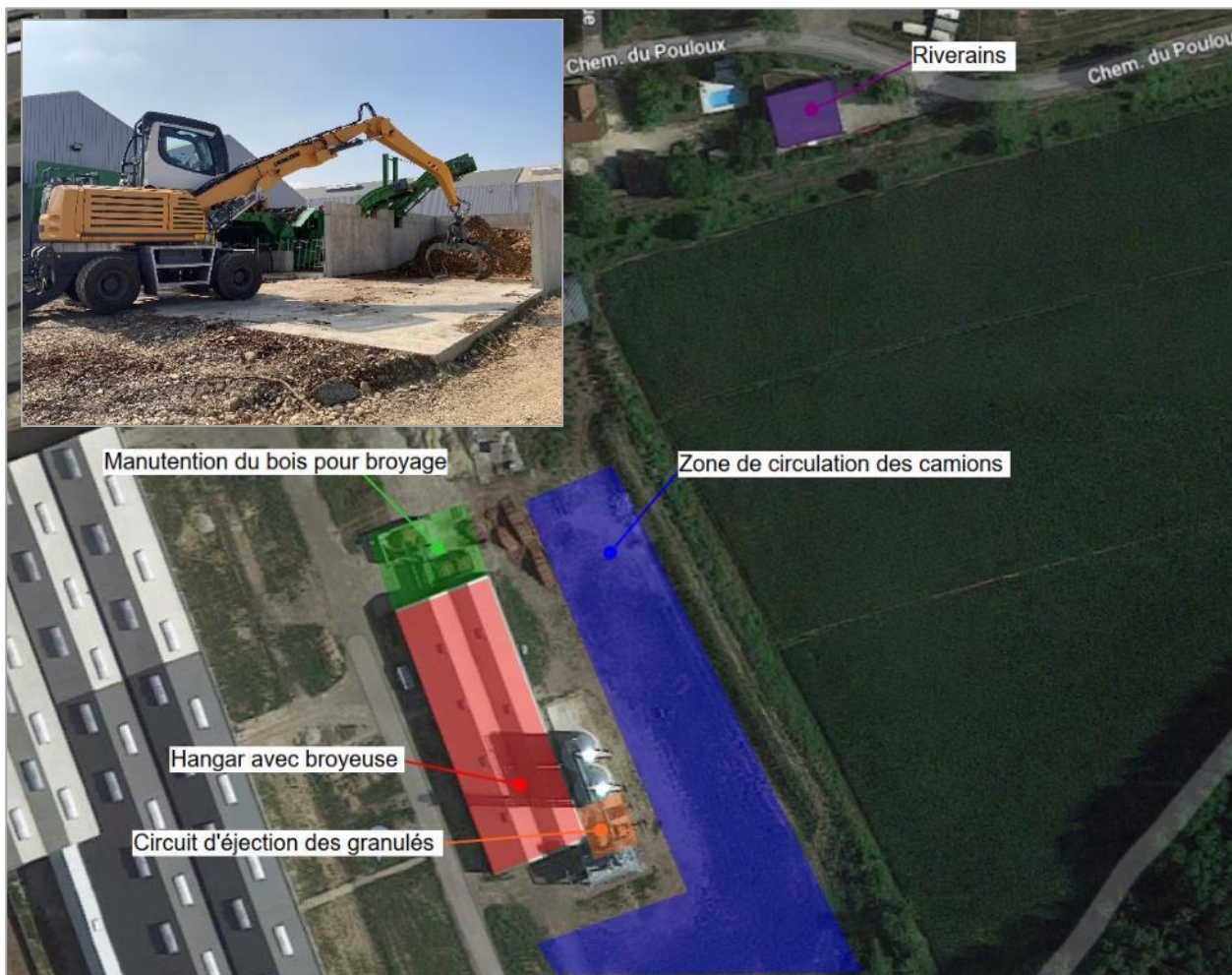
Figure 2 - Repérage des sources sonores repérées sur site
