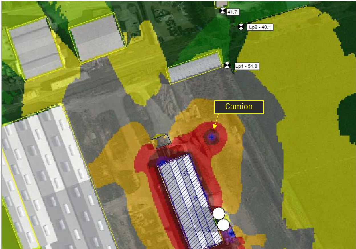
Figure 12 - Cartographie de propagation sonore - Simulation d'un camion à l'arrêt (moteur en fonctionnement) avec ajout d'un écran acoustique
