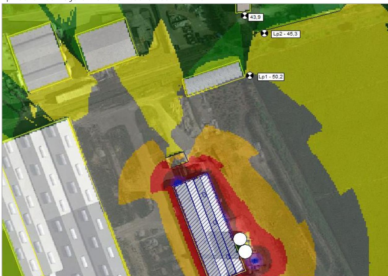
Figure 7 – Cartographie de propagation sonore de l'état initial – Tous équipements en fonctionnement
