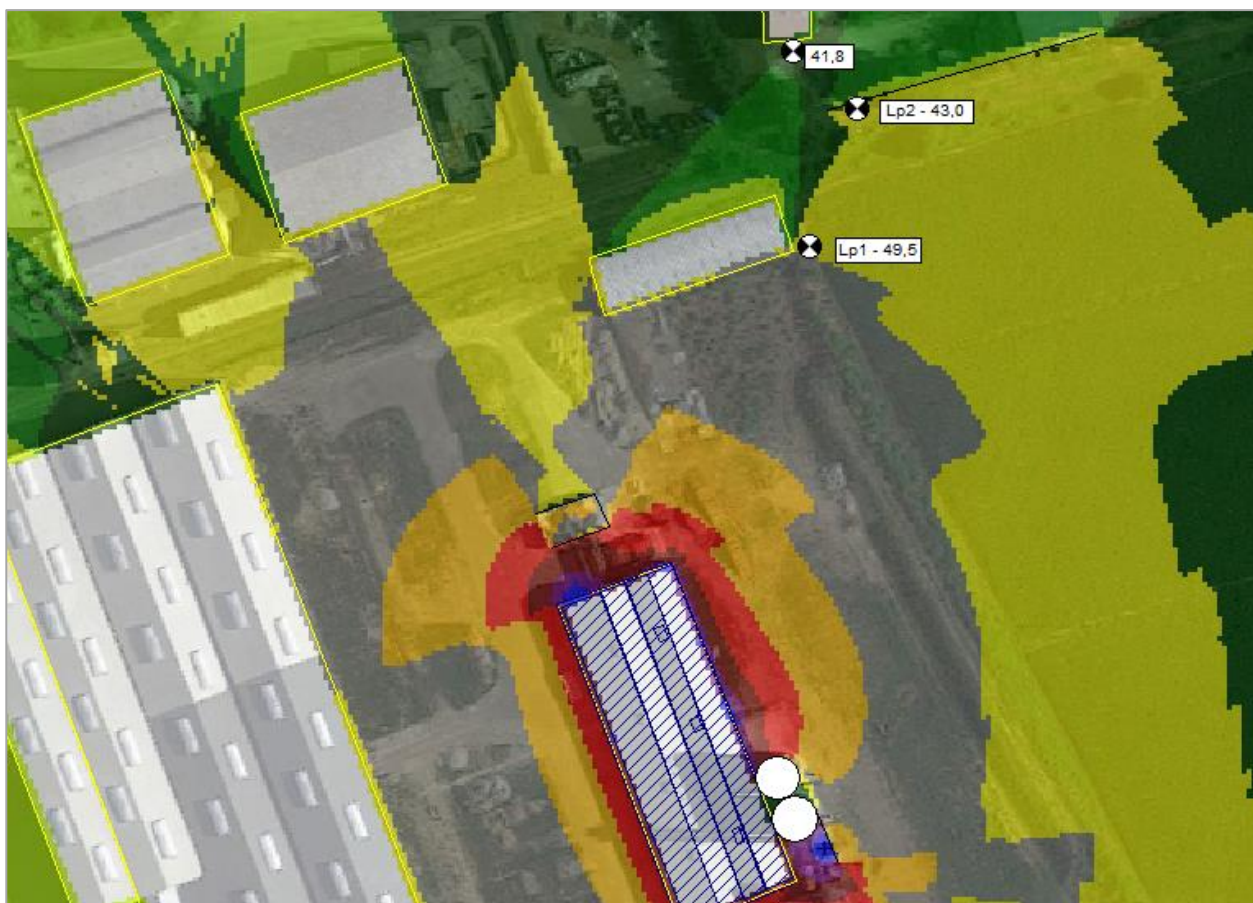
Figure 9 – Cartographie de propagation sonore du scénario n°1 – Ajout d’un écran de 4m coté éjection des granulés
