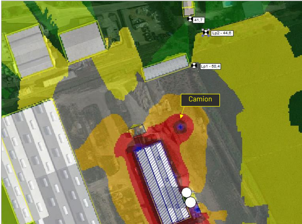
Figure 11 - Cartographie de propagation sonore - Simulation d'un camion à l'arrêt (moteur en fonctionnement)
